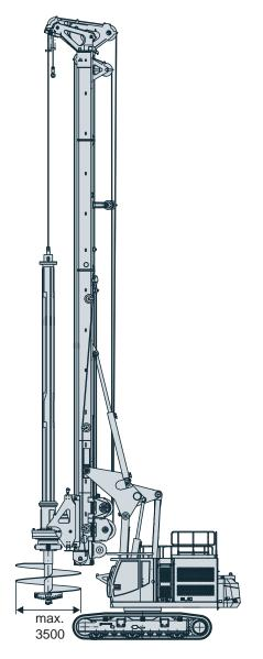
mit kurzem Mäklerfuss with short mast foot
